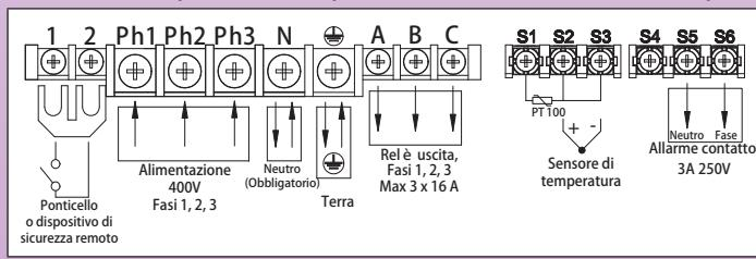
Circuito unipolare, uscita SSR incorporata 10A, un allarme 3Amp
