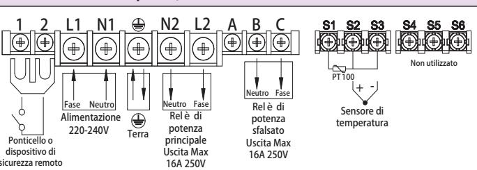
Circuiti a 3 poli, 2 uscite a relè sfalsate 3x16A 250V
