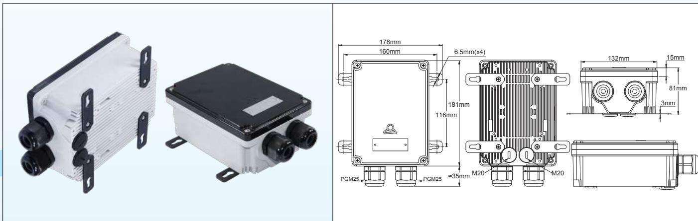
Queste scatole sigillate in alluminio sono verniciate con vernice epossidica RAL 7015. Hanno le stesse dimensioni delle scatole di comando in plastica e utilizzano coperchi piatti. Utilizzano le stesse lingue di montaggio a parete dei modelli in plastica. Sono state progettate per il montaggio di relè a stato solido monofase o trifase il cui raffreddamento è assicurato dalle alette sul lato posteriore.
