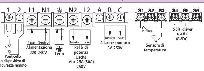
Circuiti a 3 poli, 3 x 16Amp uscita a relè , un allarme da 3Amp
