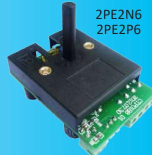
Termostato elettronico cieco, intervalli di
