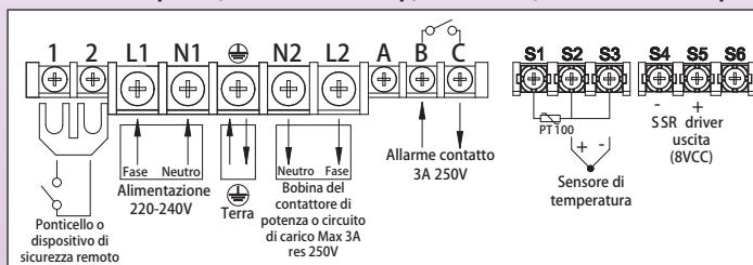
Circuiti unipolari, 2 uscite a relè sfalsate 16A 250V
