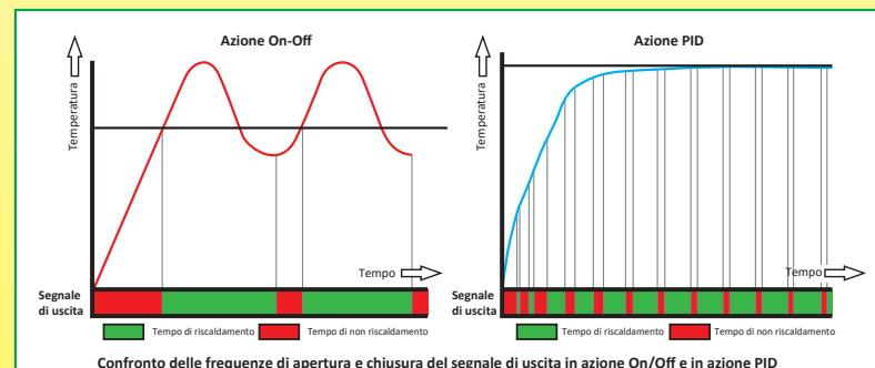
Se l'azione PID può migliorare il controllo in un certo numero di configurazioni, lo svantaggio è che il segnale di uscita si attiva molto rapidamente, il che riduce notevolmente la durata dei relè di potenza e richiede, nella maggior parte dei casi, l'uso di relè a stato solido.
