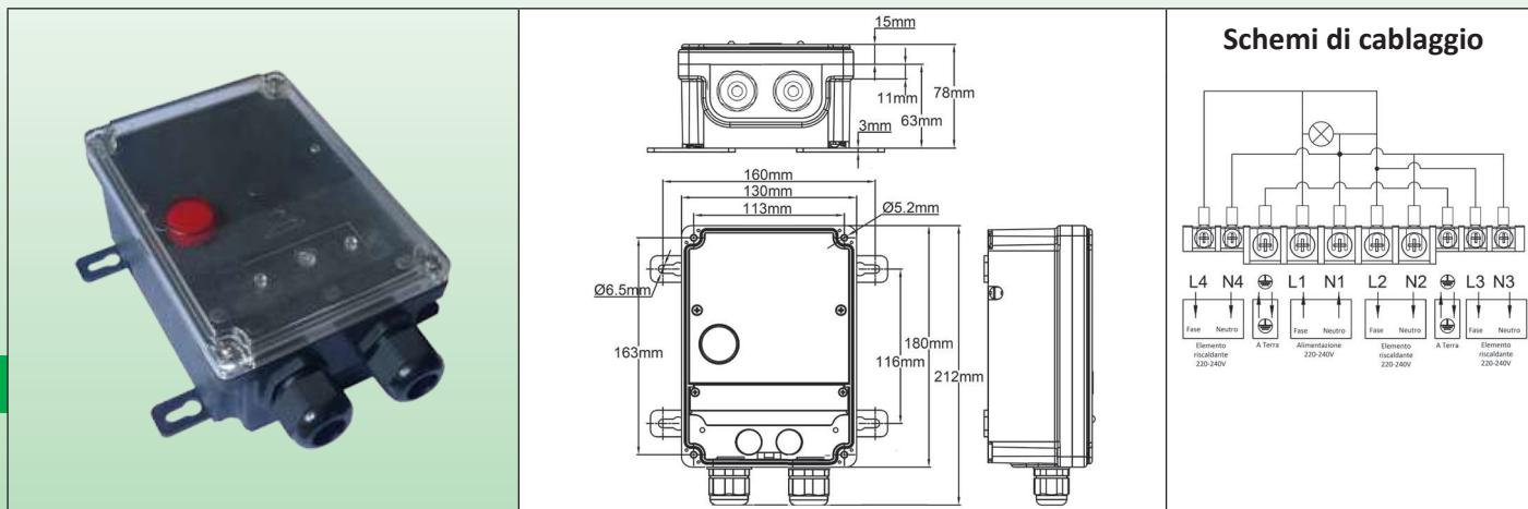
**Cablaggio:** alimentazione Neutro + Fase + Terra su una morsettiera da 6 mm<sup>2</sup> e uscite su 3 prese del circuito di riscaldamento da 1.5 o 2.5 mm<sup>2</sup>.
