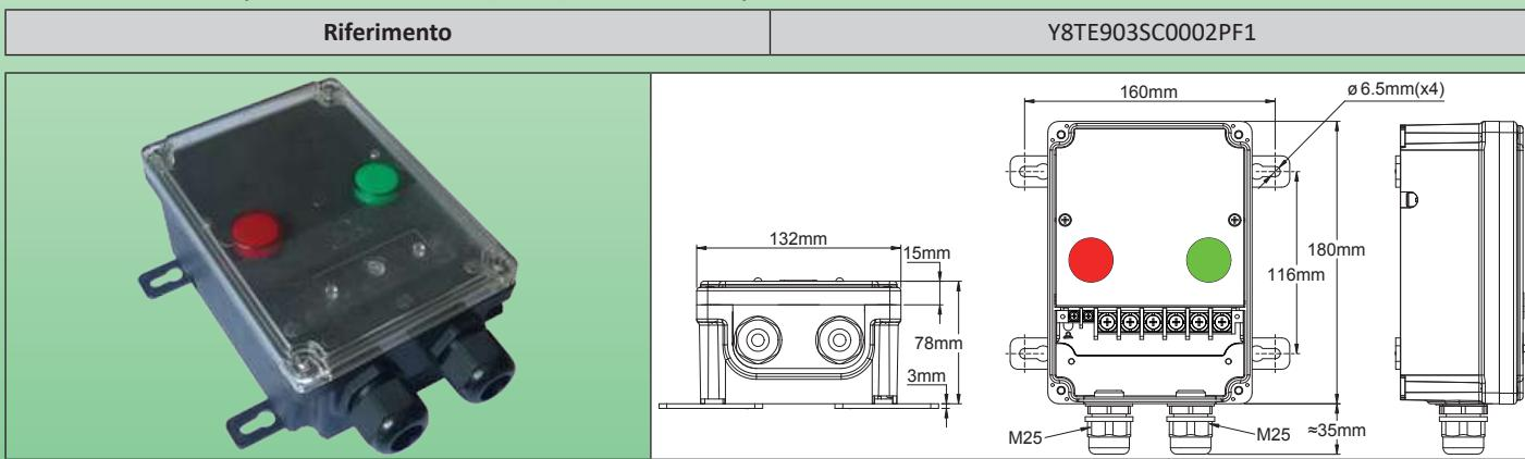
3 × 25A (AC1), 250V, morsettiera con 2 morsetti a vite da 2.5mm<sup>2</sup> e 6 morsetti a vite da 10mm<sup>2</sup>. Spia rossa per l'alimentazione e spia verde in uscita (250V), coperchio trasparente.
