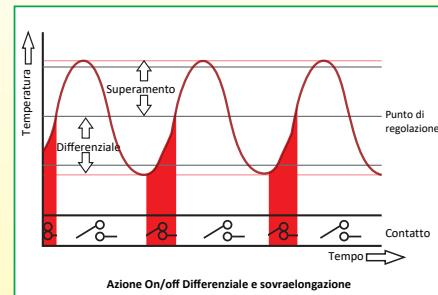
**Differenziale regolabile:** Un differenziale basso è spesso associato alla precisione del controllo. Tuttavia, un differenziale troppo basso provoca cicli brevi di riscaldamento e l'usura prematura dei contatti se si utilizza un relè di potenza, oppure un rapido degrado del compressore se il sistema viene utilizzato per controllare un frigorifero. I regolatori elettronici di questo catalogo hanno un differenziale regolabile per ottimizzare questo funzionamento.
